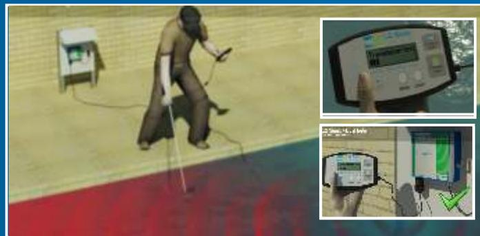
Двойной тестер может быть использован для проверки работы установки - посылает ли блок питания все правильные частоты (подключается тестер на выходе преобразователя). Кроме того, он также может быть использован для проверки частот, излучаемых в воду. Двойной тестер был разработан, чтобы измерять правильные частоты, испускаемые LG Sonic® и при этом он не измеряет любые гармонические шумы или бесполезные частоты, что делают обычные счетчики дБ.
